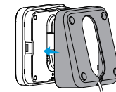
3. 将底座如图方向, 卡入机身卡扣内, 固定牢固。
