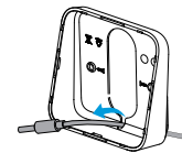
1. 将电源线穿过底座线槽。
